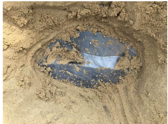
Figure 7. Géomembrane sous vive tension
